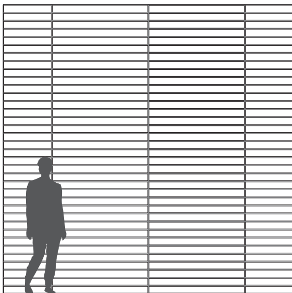
Troldtekt V-Line 2way 6, montiert in waagrechtem Kreuzverband.
