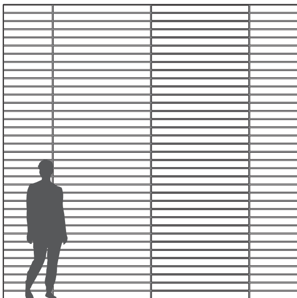
Troldtekt V-Line 2way 6, montiert in waagrechttem Kreuzverband
