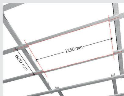
**B:** Schienensystem, vorbereitet für die Montage einer 1200 mm Revisionsklappe.
