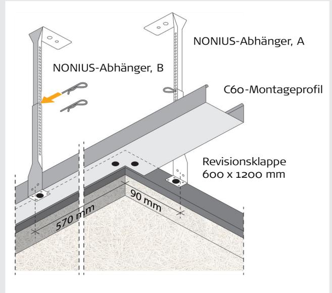
**C:** Den Außenrahmen auflegen und mit sieben Schneideschrauben an den Schienenbefestigen. Anschließend kann die Revisionsklappe aufgelegt werden.
