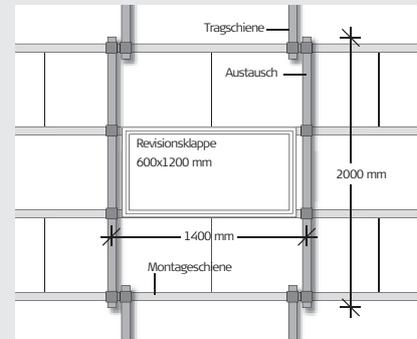
Austausch: 2 Tragschiene werden unterbrochen
