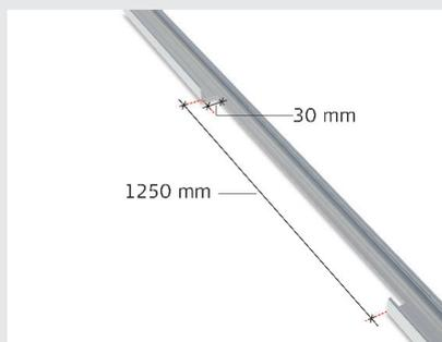
**A:** Eine Aussparung für die Montage in den beiden C60-Schienen schneiden, die die Revisionsklappe tragen sollen.
