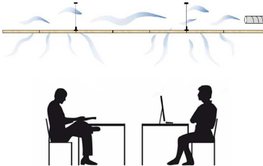
Abbildung 2: Anlage für die diffuse Deckenlüftung
