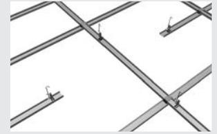
**2:** Die Fix-Anker-Schnellabhänger in die frei hängenden Montageschienen montieren.
