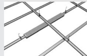
**5:** Die Armatur kann eventuell zusätzlich gestützt werden. Dazu die Armatur mit einer Schneidschraube an der Tragschiene befestigen.
