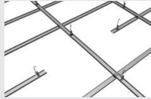
**2:** Die Fix-Anker-Schnellabhänger in die frei hängenden Montageschienen montieren.
