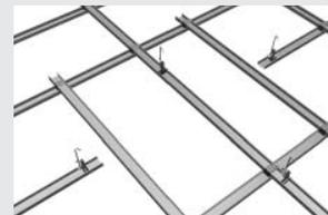
**3:** Zwei zusätzliche Tragschienen montieren. Diese mit Kreuz-Schnellverbindern an den Montageschienen befestigen.
