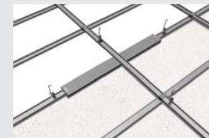
**6:** Die Troldtekt-Platten montieren. Die Troldtekt-Platten werden mit vorgeschrittenen Löchern für die Armatur sowie einer Nutung für den Armaturenflansch geliefert.
