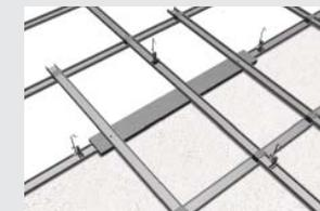
**5:** Die Troldtekt-Platten montieren. Die Troldtekt-Platten werden mit vorgeschrittenen Löchern für die Armatur sowie einer Nutung für den Armaturenflansch geliefert.
