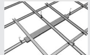
**4:** Die Armatur mit Schneidschrauben an den beiden Tragschienen befestigen.
