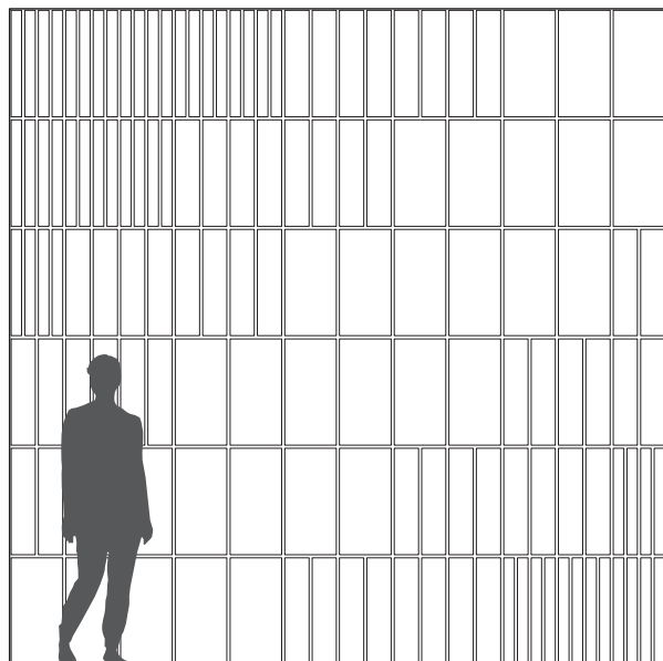
Troldtekt Tiles fortlaufend montiert
