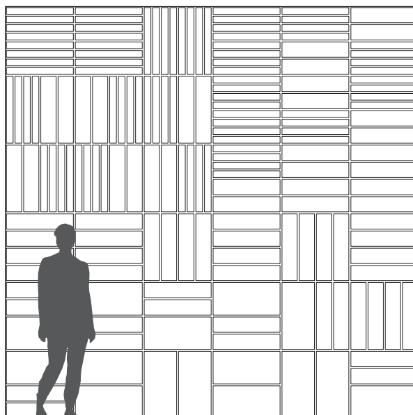
Troldtekt Tiles in zufälligem Muster montiert
