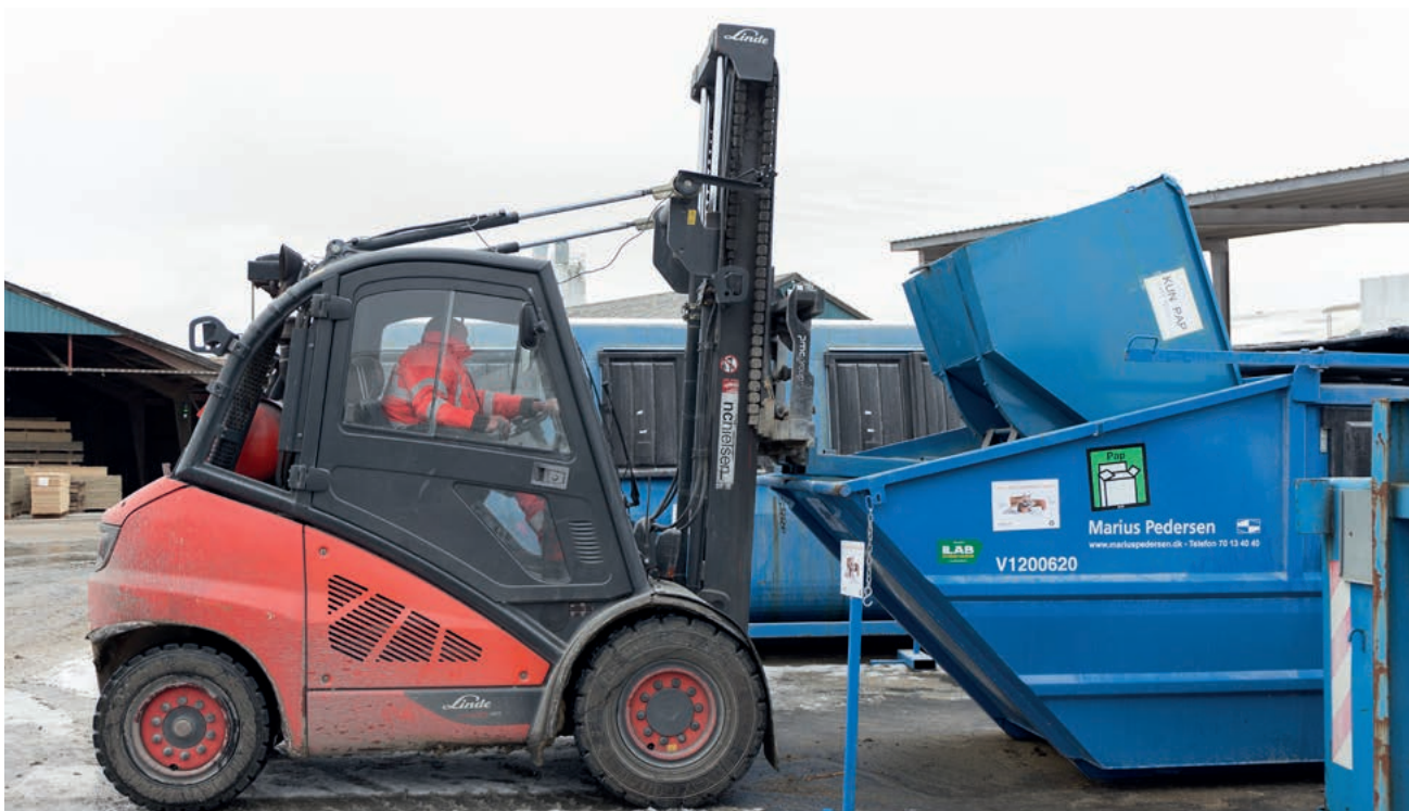
▲ Die Muldenbehälter werden mit dem Gabelstapler in die Container geleert – Handarbeit überflüssig.
