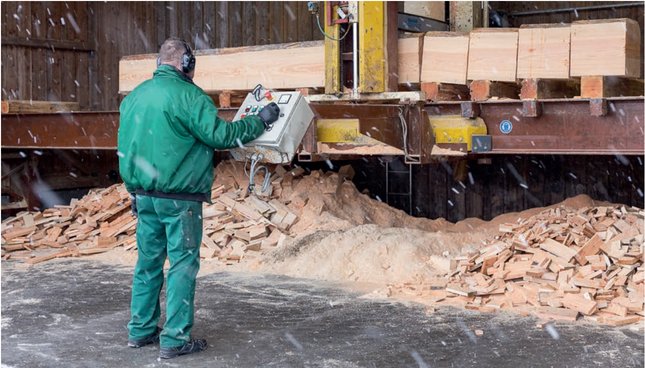
▲ Auf einer der großen Sägen des Sägewerks wird ein großer Eichenstamm in Blöcke geschnitten.
