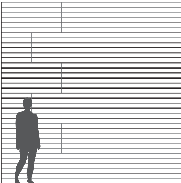
Troldtekt V-Line 1way 6, montiert in waagerechtem Halbverband.
