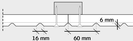
QUERSCHNITT V-line 2way blank
