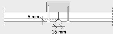
QUERSCHNITT V-line 2way 6
