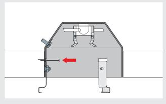
**2:** Den Transformator montieren und die Armatur danach mit Stiften an der Troldtekt-Platte festdrücken.
