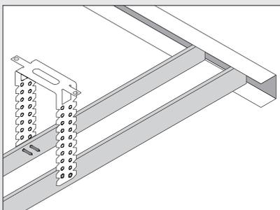
**2:** Nehmen Sie eine C-Schiene mit der Öffnung nach oben, und schrauben Sie den Direktabhängler in der gewünschten Höhe an der Seite der Schiene fest (Schrauben liegen bei). Den überschüssigen Teil des Direktabhänglers können Sie einfach nach oben biegen. Verbinden Sie die C-Schienen der Länge nach mit Längsverbindern, und schließen Sie die C-Schienen im U-Profil ab.
