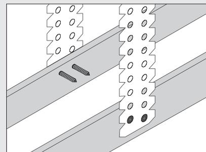
**3:** Teilen Sie die Decke so weit wie möglich auf, damit auf beiden Seiten Anpassungsmöglichkeiten von min. 300 mm vorhanden sind.
