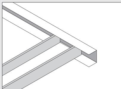
**1:** Zeichnen Sie an allen benachbarten Wänden die waagerechte Ebene in der gewünschten Höhe an. Zeichnen Sie die Unterseite des U-Profils an, und befestigen Sie es mit 6 mm Dübeln in vorbereiteten Löchern an der Wand. Legen Sie die Verankerungspunkte für die C60-Schienen fest, und zeichnen Sie sie an. Montieren Sie immer den ersten Direktabhängler max. 300 mm von der Wand. Teilen Sie die restlichen Direktabhängler mit einem max. Abstand von 1200 mm auf.
