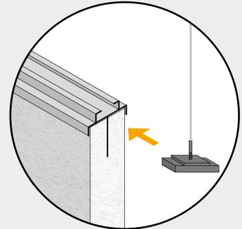
**2:** Fixieren Sie die Drahtseile in der Aluminiumschiene, indem Sie die Klemmschuhe in der Schiene drehen.
