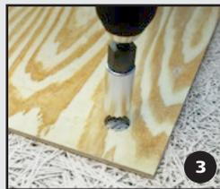
Verwenden Sie den Becherbohrer, um kleine Stücke zementgebundener Holzwolle aus der überschüssigen Platte oder Warenprobe heraus zu bohren. Die Stücke müssen den gleichen Durchmesser wie die Löcher haben
