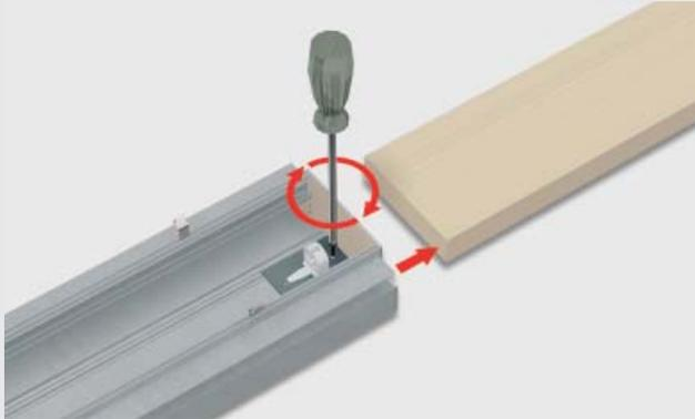
1: Die Armatur an beiden Enden an der Unterlage befestigen.
