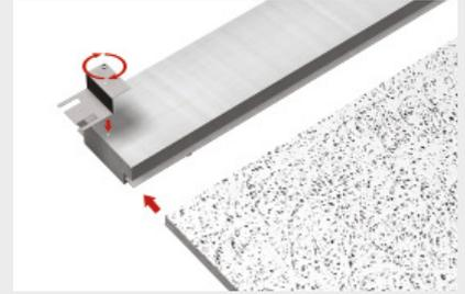
**3:** Den Z-Beschlag montieren und den Flansch über die Trolldtekt-Platte schieben.
