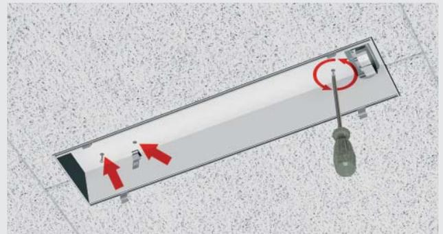
**4:** Reflektor einsetzen und festschrauben. Die Halteclips für die T5-Leuchtstoffröhre andrücken.
